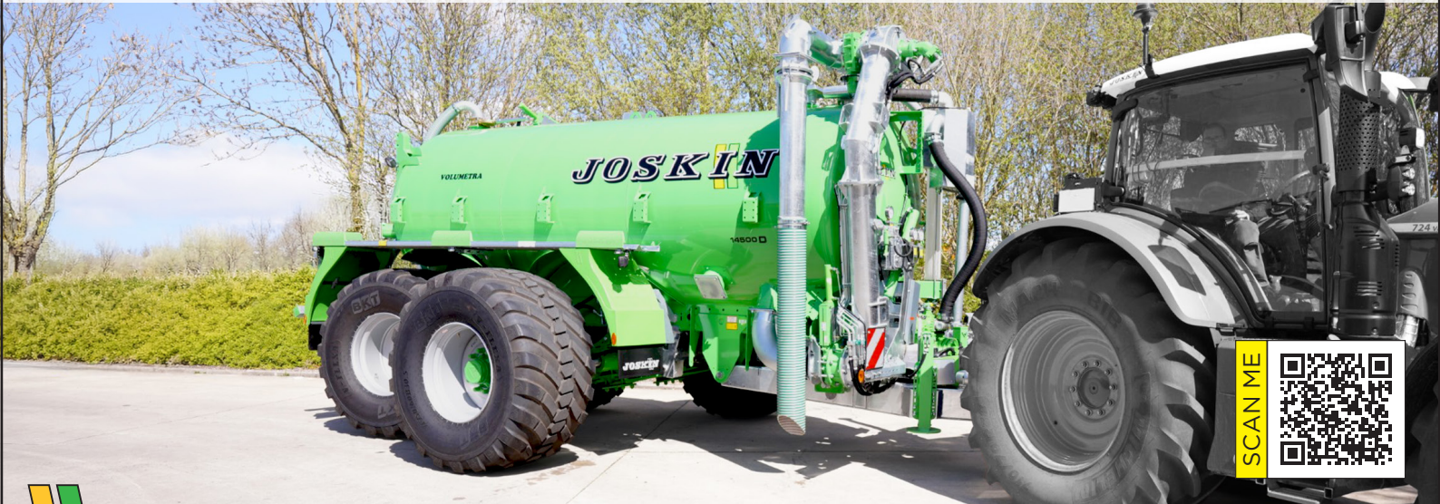
13 t ausfahrbare Achse 700 mm (auf starrer Achse)
